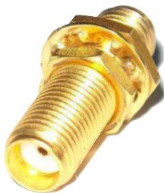
Obr. 4.3: Koaxiální přechodka SMA.
