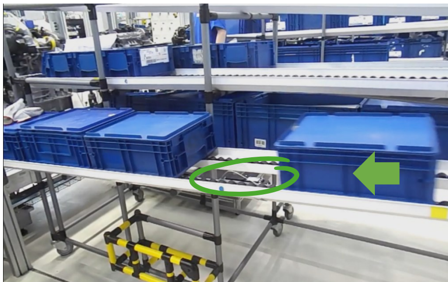
Obr. 4.4 Umístění senzoru SAS na spádovém skluzu
