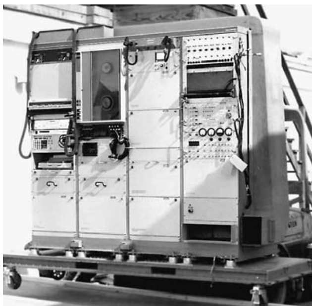
Obr. 2.2: Experimentálny štvorkanálový GPS prijímač Circa 1978 s funkciou zaznamenávania výsledkov. Testy prebiehali na palube lietadla C-141. V čase testov existovali len štyri satelity na obežnej dráhe, preto test musel byť vopred naplánovaný v určitom čase a mieste, kde bola dostupnosť satelitov [2].
