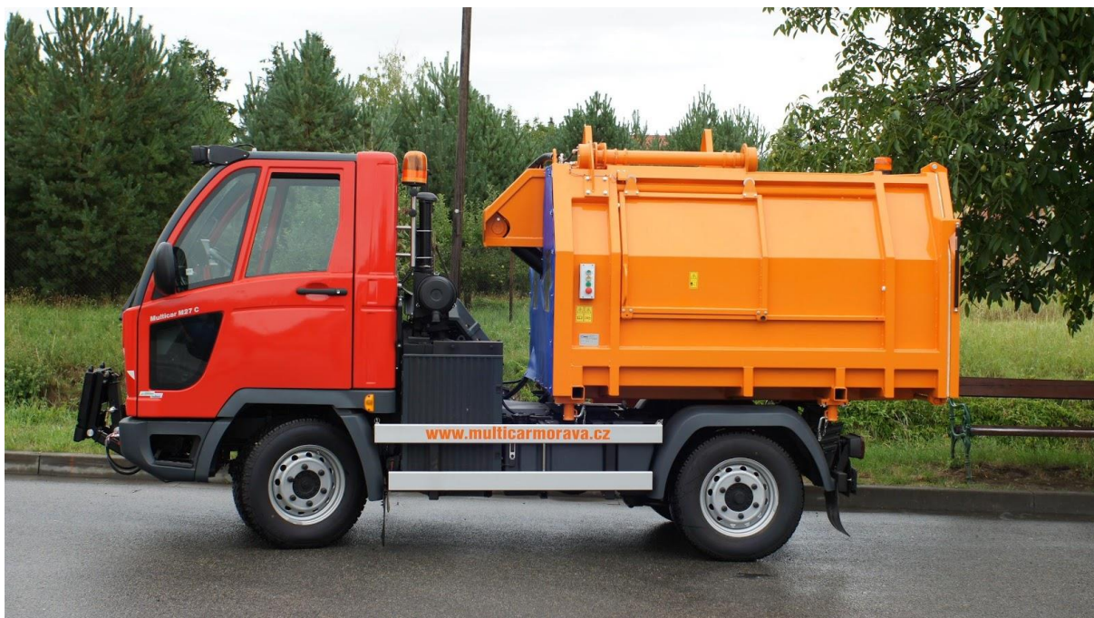
obrázek 10 - nástavba M27 FUMO na vozidle Multicar M27 compact, zdroj:
