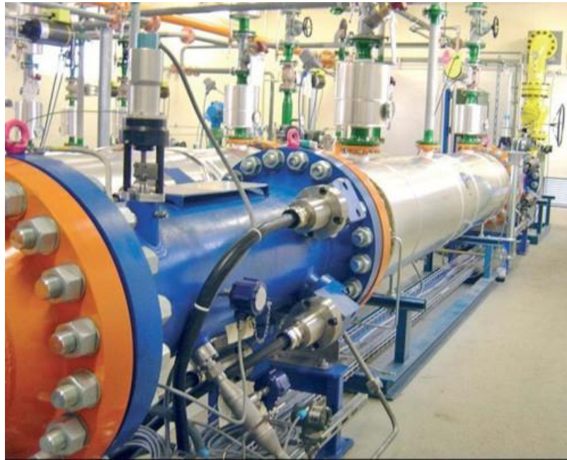
Obr. 28 Expanzní turbína S2M 300 kWe s magnetickými ložisky [7]
