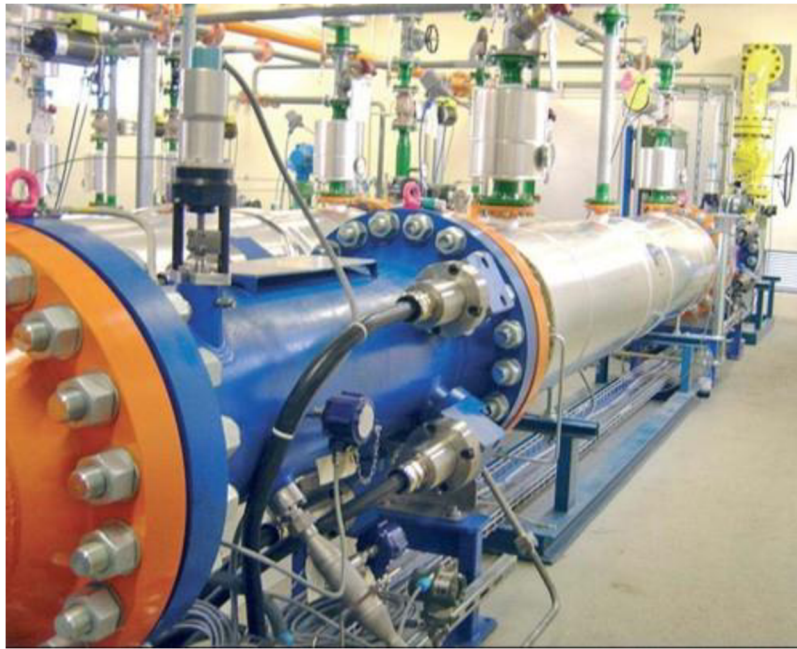
Obr. 28 Expanzní turbína S2M 300 kW s magnetickými ložisky [7]
