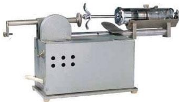
Obr. 1 Lineární dávkovač podle Dr. Hesse [5]
