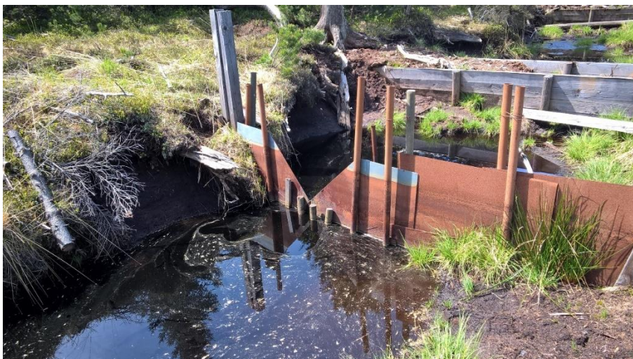
Obrázek 36: Thomsonův měrný přeliv V-1 (Moučka, 2017)
