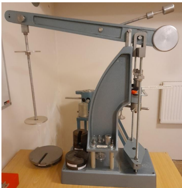
Obr. 5-4 Mechanický edometrický přístroj s pákovým mechanismem zatěžování. Na této fotografii bez osazeného vzorku a přípravku pro upevnění bender elementů.
