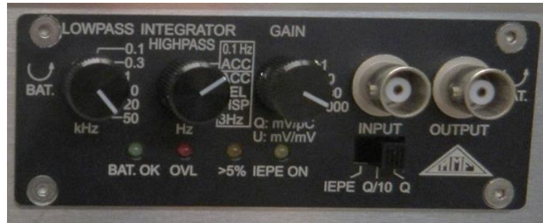
Obr. 6-3 Panel ovladače generátoru signálu a osciloskopu integrovaných do jednoho zařízení. První ovladač vlevo slouží k nastavení hodnoty LP filtru
