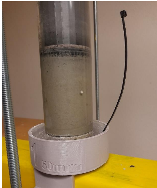
Obr. 5-3 Konsolidační válec pro přípravu rekonstituovaných vzorků. Svislé tyče slouží k nanesení napětí na horní povrch vzorku.
