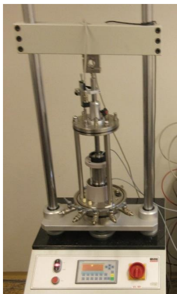
Obr. 5-6 Automatický zatěžovací rám používaný pro zkoušku druhého rekonstituovaného vzorku i všechny následující zkoušky.
