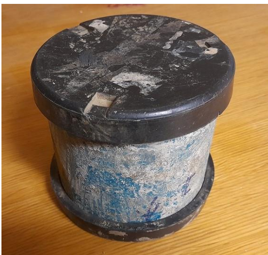
Obr. 5-10 Neporušený vzorek uvnitř pouzdra a uzavřený gumovými víky. Během skladování byl ještě celý vzorek včetně pouzdra a vík zabalen ve fólii pro omezení změn vlhkosti. Průměr vzorku je 125 mm.
