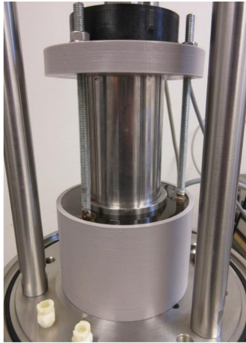
Obr. 4-1 Fotografie přípravku s osazeným vzorkem zeminy a kovovými podstavami.
