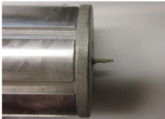
Obr. 2-3 Bender element požitý během zkoušek. Na tomto obrázku je instalován spolu s pouzdem v horní podstavě přípravku umožňující zatěžování vzorku.
