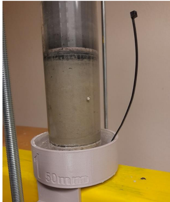
Obr. 5-3 Konsolidační válec pro přípravu rekonstituovaných vzorků. Svislé tyče slouží k nanesení napětí na horní povrch vzorku.
