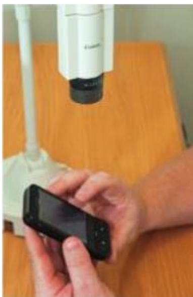
Obr. 3 Kamera pro testování mobilních telefonů Zdroj: Barnum, 2011.
