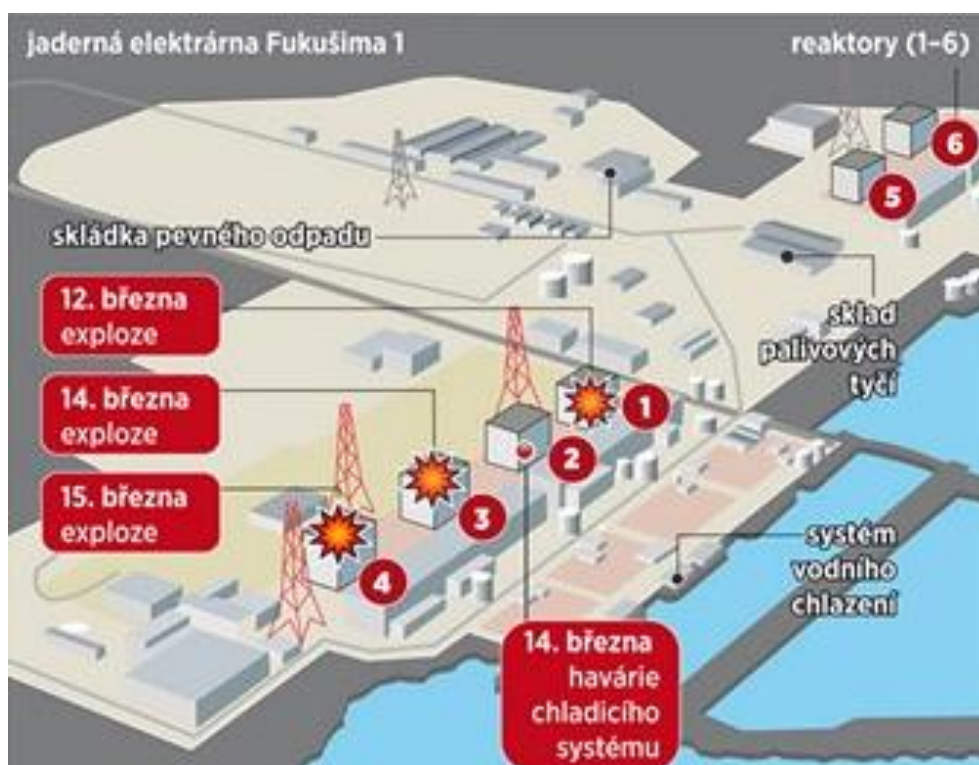
Obrázek č.7 JE Fukushima Daiichi – přehled poškození RB a důležitých systémů – převzato z [16]
