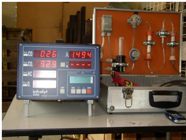
Obr. 74 On-line analyzátor plynu Infralyt 5000
