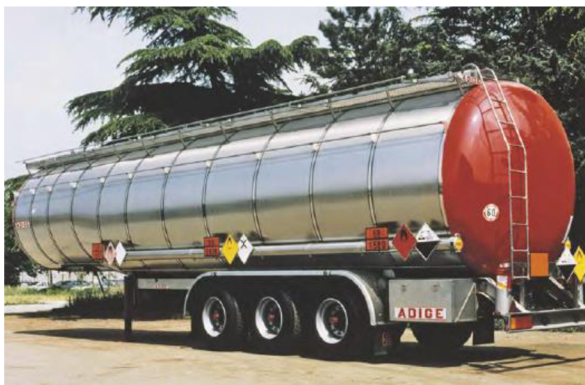
Obr. 1 Cisterna z duplexní oceli [7].
