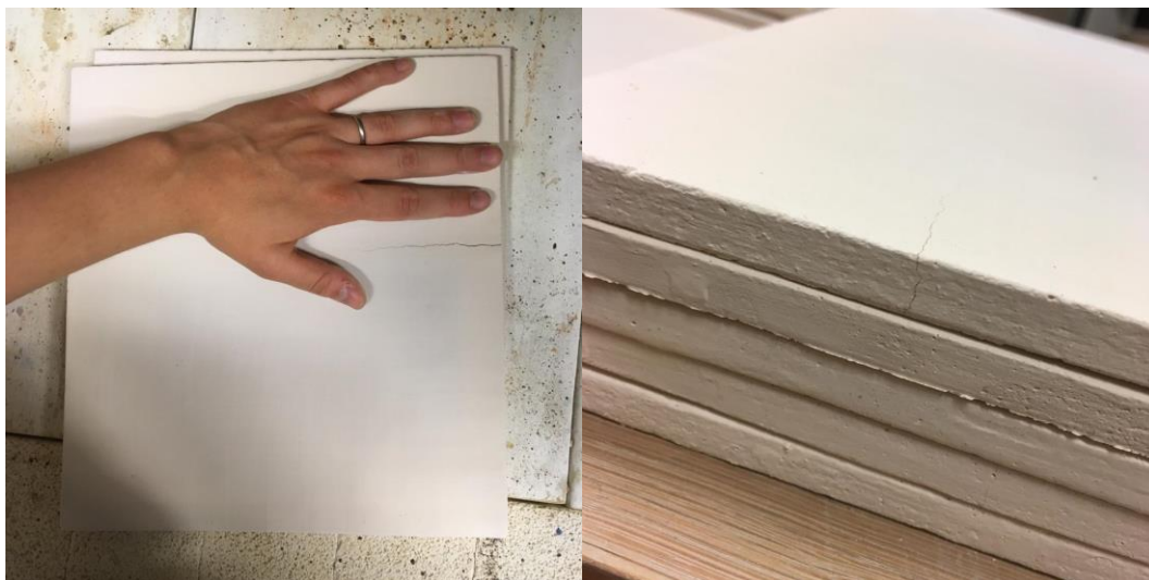
Obrázek 13 – Praskliny na dlaždicích vzniklé při přežahu. Ruku jsem si fotila jako měřítko velikosti praskliny
