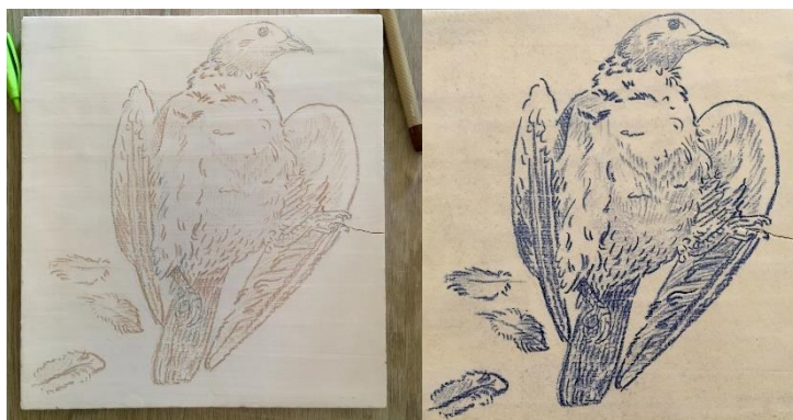
Obrázek 14 - Pokreslená prasklá dlaždice před a po ostrém výpalu – prasklina se ani nehnu
