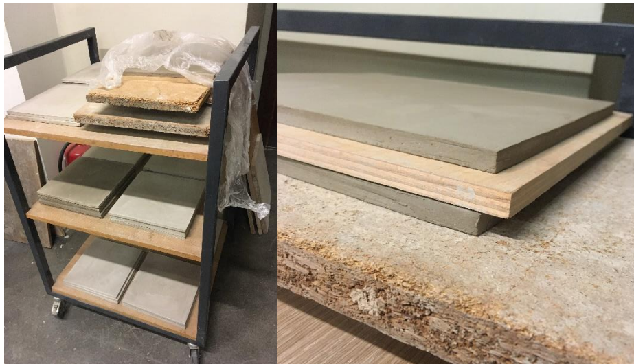
Obrázek 8 – Sušení dlaždic mezi dřevěnými deskami a jejich uskladnění
