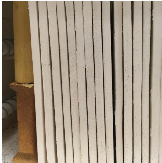
Obrázek 12 – Dlaždice naskládáné v peci. V této chvíli již po přežahu s viditelnými prasklinami
