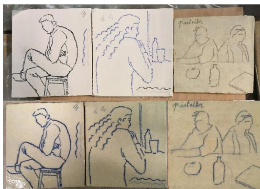
Obrázek 17 – Zkouška kobaltových voskovek a pastelek (před a po ostrém výpalu)
