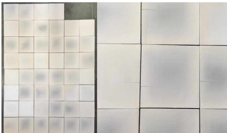
Obrázek 18 - Dlaždice vyskládané po přežahu. Fleky jsou způsobené nezáměrnou redukcí
