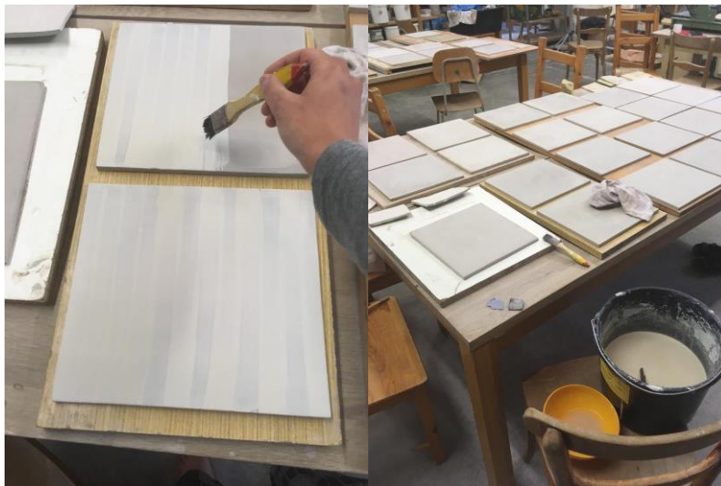
Obrázek 11 – Pracovní prostor při natírání dlaždic bílou engobou
