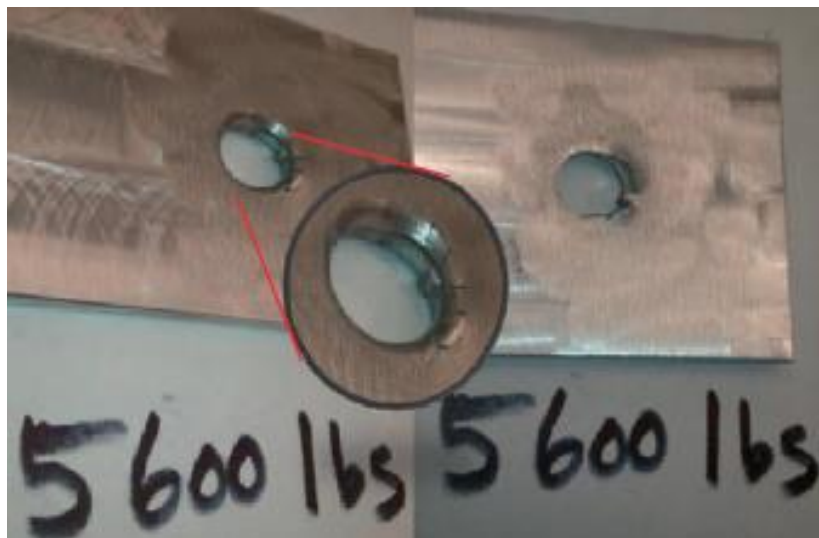
Obrázek 15 - Výsledek tahové zkoušky ověřující kvalitu nástřiku
