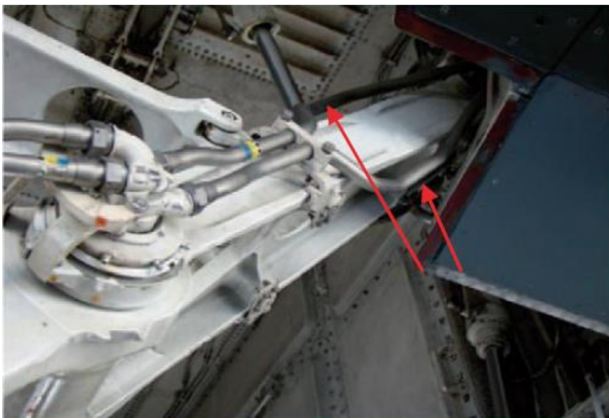
Obrázek 12 - Poškozená místa hydraulického vedení
