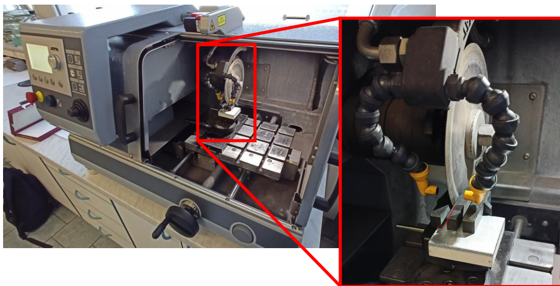
Obrázek 25- Řezání vzorku na metalografické pile Brillant 220
