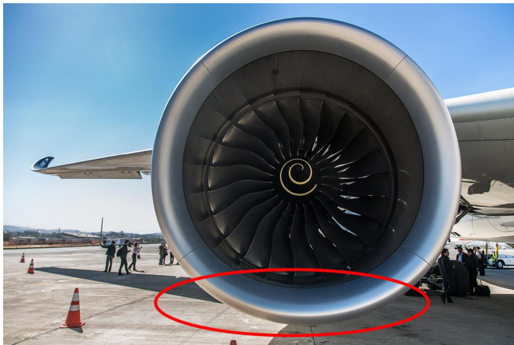
Obrázek 11 – Místo, kde došlo ke korozi
