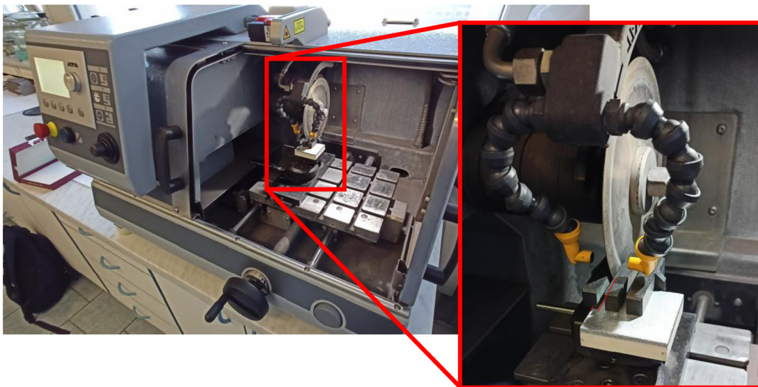
Obrázek 25- Řezání vzorku na metalografické pile Brillant 220
