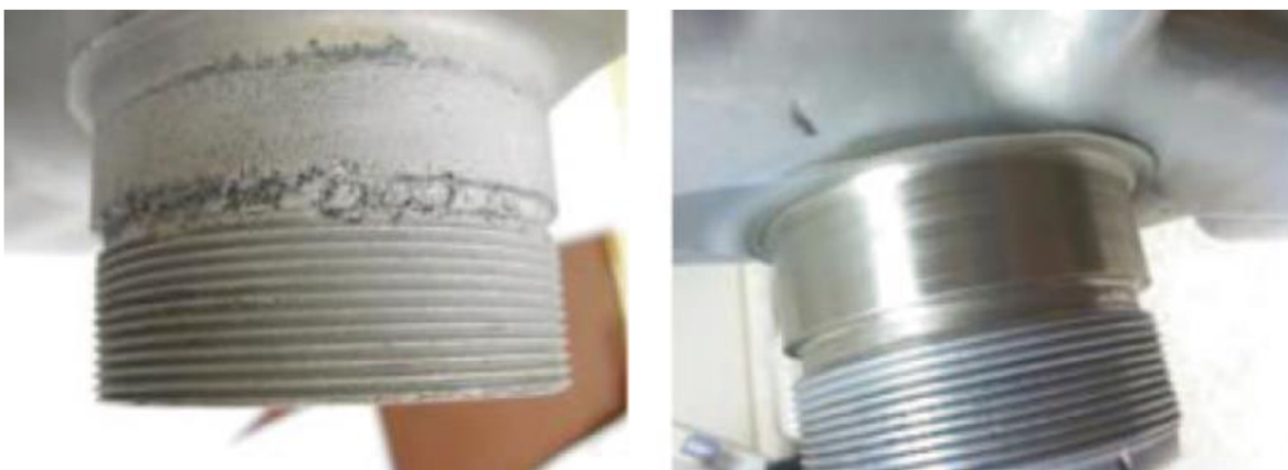
Obrázek 9 - Oprava akčního členu podvozku metodou CS za použití niklových slitin
