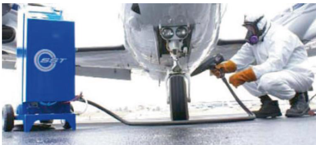
Obrázek 10 - Využití přenosného CS pro opravu předového podvozku
