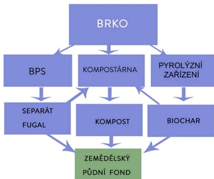
Obr. č. 18: Propojení technologií zpracování BRKO (zdroj: vlastní vypracování na základě podkladů Hejátkové, 2018)
