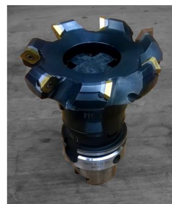
Obr. 47 Čelní fréza Ø 100 mm.
