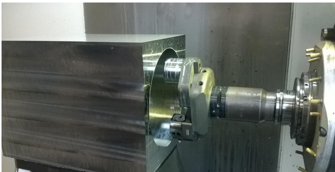
Obr. 81 Hrubování \varnothing 200 mm.
