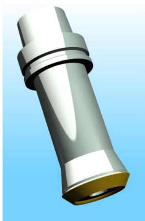
Obr. 35 Hrubovací čelní fréza \varnothing 63 mm.
