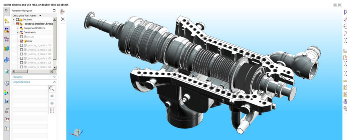
Obr. 54 Část sestavy turbíny v NX10.
