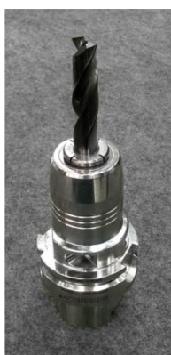
Obr. 44 Vrták SK Ø 14 mm.
