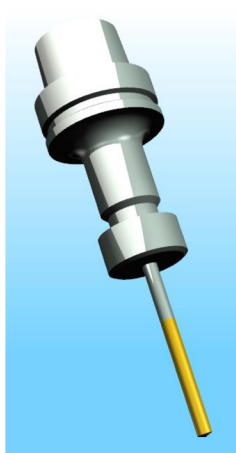
Obr. 38 Vrták SK \varnothing 14 mm.
