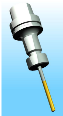
Obr. 42 Vrták SK Ø 7 mm.
