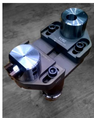
Obr. 46 Vyvrtávací tyč Ø 200 mm.
