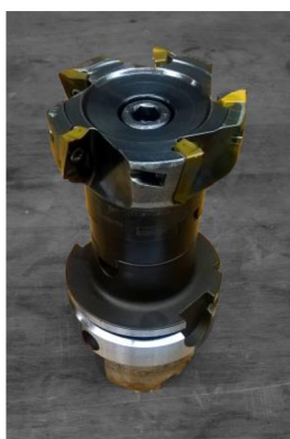
Obr. 45 Rohová fréza Ø 66 mm.
