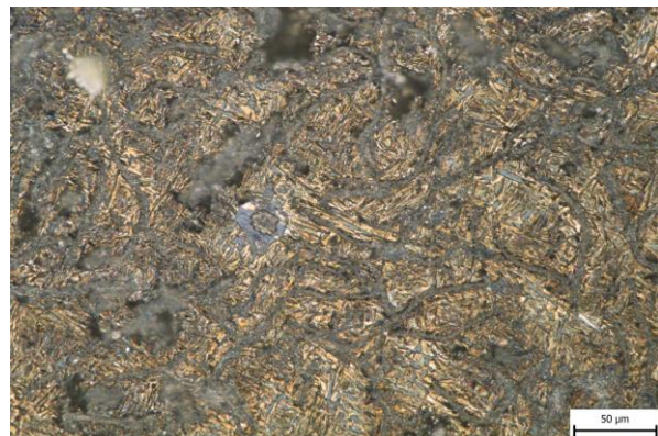
Obr. 42 Vzorek 43DA, Beraha I, 2 min, zvětšení 500x.
