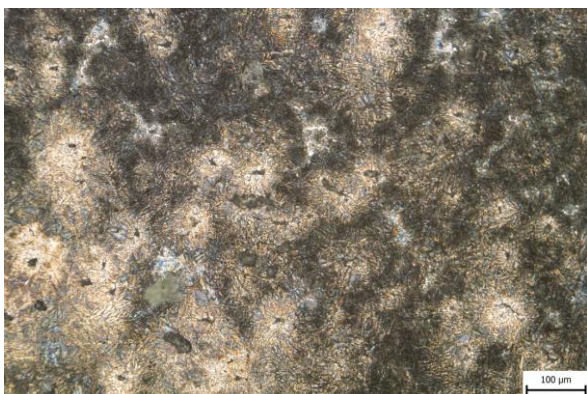
Obr. 96 Vzorek 43DA, Beraha-Martenzit, 40 s, zvětšení 200x.
