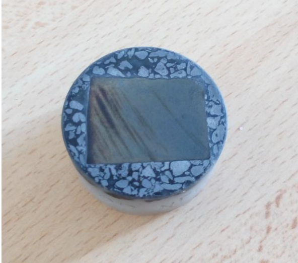
Obr. 84 Vzhled vzorku 83DA po vyjmutí z barevného leptadla a jeho očištění.
