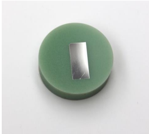
Obr. 1 Vzorek zalitý do pryskyřice za studena [4].
