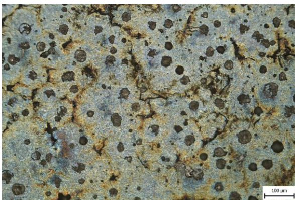
Obr. 90 Vzorek 83DA, Beraha I, 4 min, zvětšení 200x.
