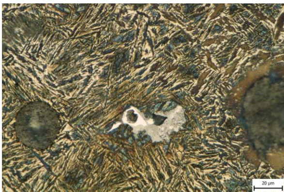
Obr. 108 Vzorek 43SA, Beraha-Martenzit, 20 s, zvětšení 1000x.
