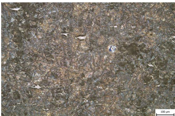
Obr. 45 Vzorek 43DA, Beraha I, 4 min, zvětšení 200x.
