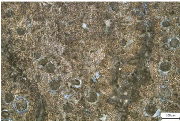
Obr. 60 Vzorek 43SA, Beraha I, 4 min, zvětšení 200x.
