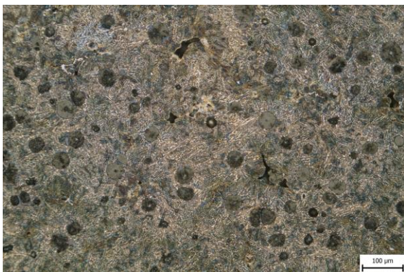
Obr. 34 Vzorek 43DA, Beraha I, 20 s, zvětšení 200x.
