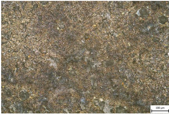
Obr. 58 Vzorek 43SA, Beraha I, 3 min, zvětšení 200x.
