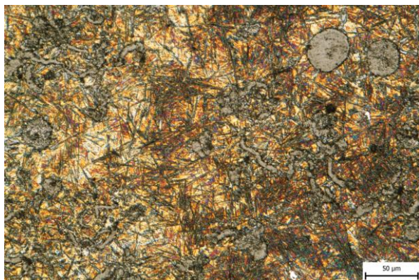
Obr. 74 Vzorek 63DA, Beraha I, 3 min, zvětšení 500x.
