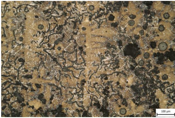
Obr. 66 Vzorek 63DA, Beraha I, 40 s, zvětšení 200x.
