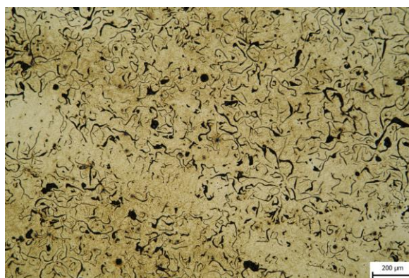
Obr. 132 Vzorek 43DA, Beraha CdS, 90 s, zvětšení 100x.
