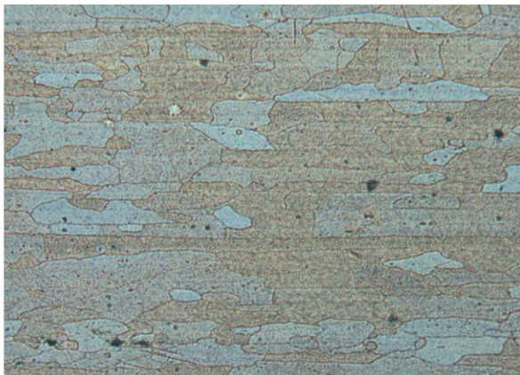
Obr. 23 Mikrostruktura válcovaného čistého Al leptaná 10% kyselinou molybdenovou (zvětšení 200x) [10].
