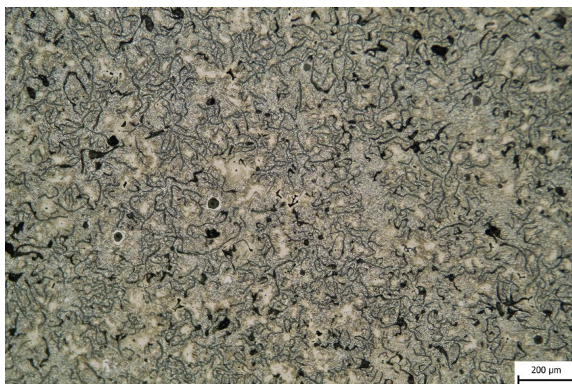
Obr. 33 Mikrostruktura vzorku 43DA po naleptání Nitalem.
