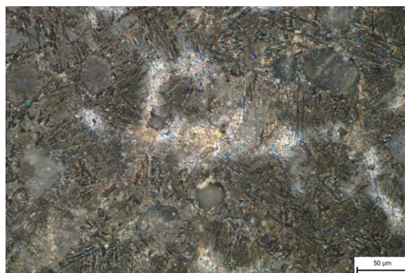
Obr. 39 Vzorek 43DA, Beraha I, 60 s, zvětšení 500x.
