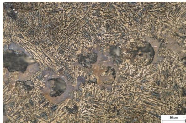
Obr. 57 Vzorek 43SA, Beraha I, 2 min, zvětšení 500x.
