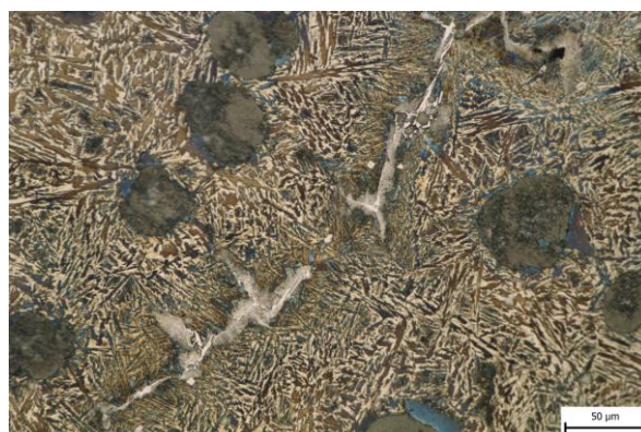
Obr. 49 Vzorek 43SA, Beraha I, 20 s, zvětšení 500x.
