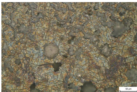
Obr. 113 Vzorek 63DA, Beraha-Martenzit, 40 s, zvětšení 500x.
