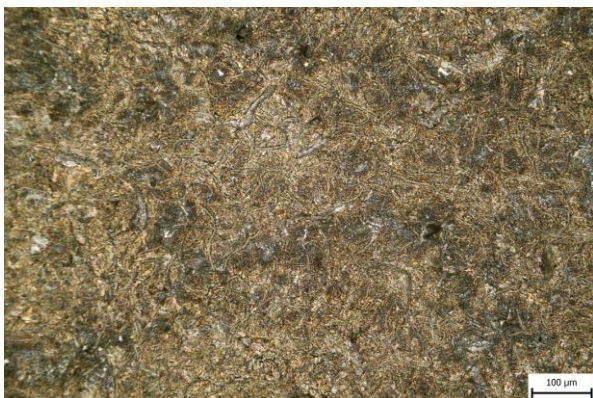
Obr. 43 Vzorek 43DA, Beraha I, 3 min, zvětšení 200x.
