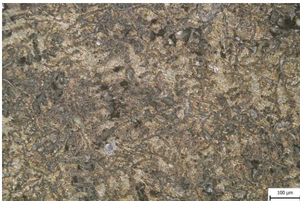
Obr. 41 Vzorek 43DA, Beraha I, 2 min, zvětšení 200x.
