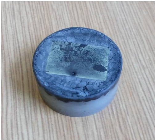
Obr. 116 Vzorek 63DA pokrytý vrstvou bílých produktů po 60 s leptání činidlem Beraha-Martenzit.
