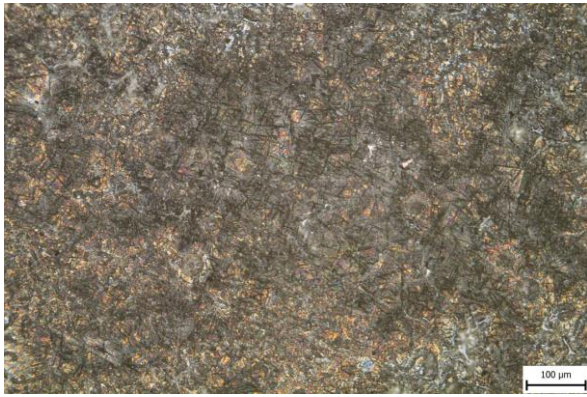
Obr. 114 Vzorek 63DA, Beraha-Martenzit, 60 s, zvětšení 200x.
