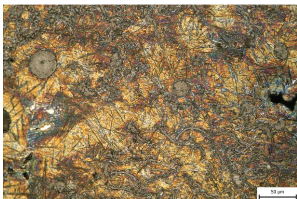
Obr. 76 Vzorek 63DA, Beraha I, 4 min, zvětšení 500x.
