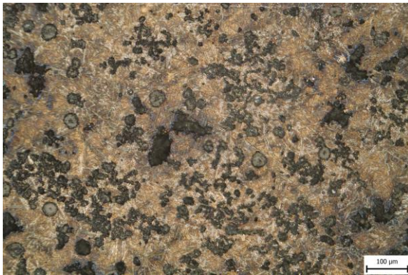
Obr. 64 Vzorek 63DA, Beraha I, 20 s, zvětšení 200x.
