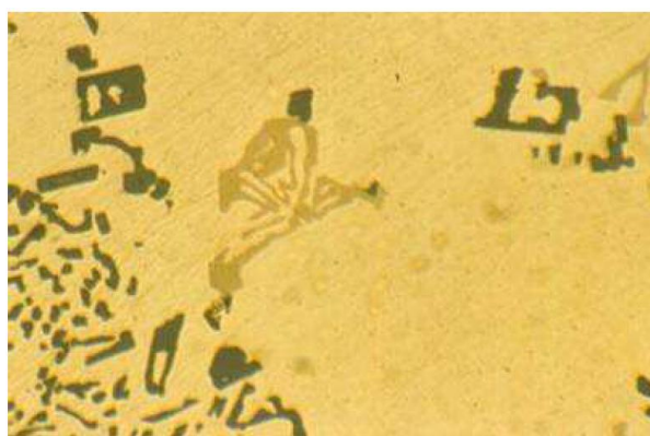
Obr. 21 Nemodifikovaný silumin AlSi10MgMn leptaný molybdenanem amonným (zvětšení 1600x) [26].
