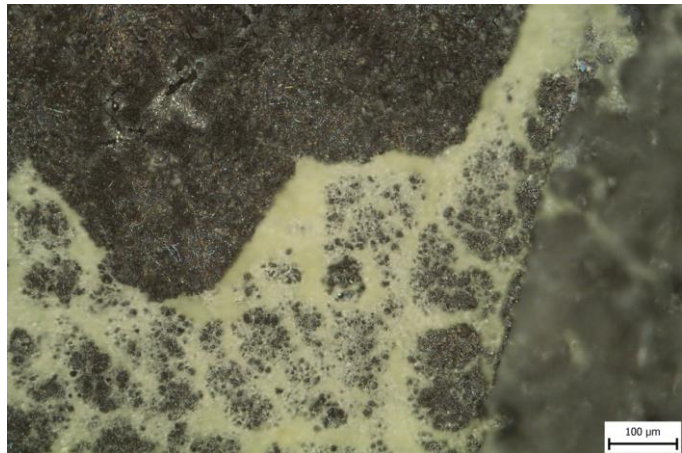
Obr. 117 Pohled na vrstvu bílých produktů u vzorku 63DA leptaného činidlem Beraha-Martenzit po 60 s (zvětšení 200x).
