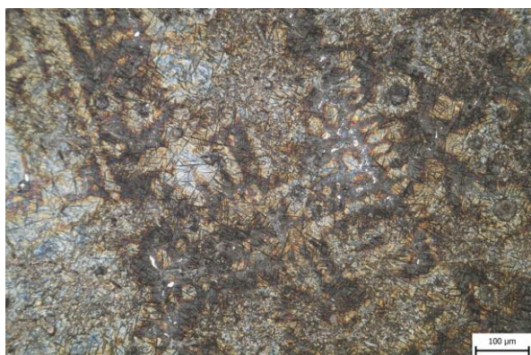
Obr. 71 Vzorek 63DA, Beraha I, 2 min, zvětšení 200x.
