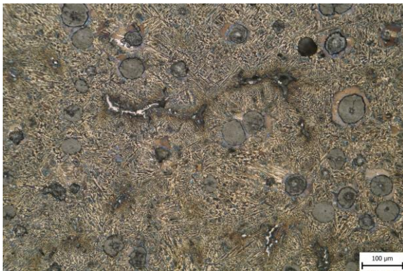
Obr. 52 Vzorek 43SA, Beraha I, 60 s, zvětšení 200x.
