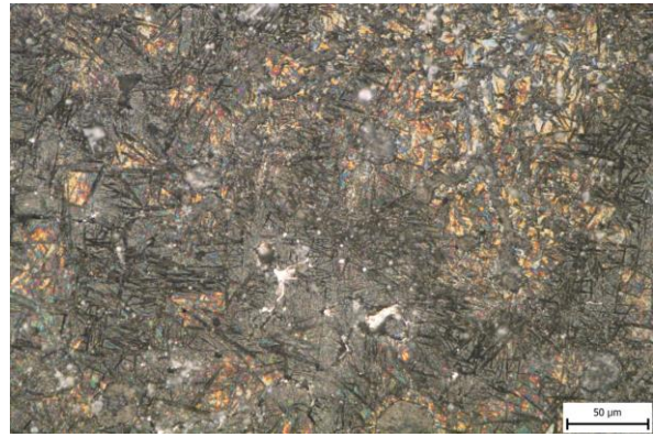
Obr. 115 Vzorek 63DA, Beraha-Martenzit, 60 s, zvětšení 500x.
