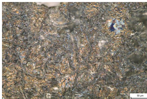
Obr. 46 Vzorek 43DA, Beraha I, 4 min, zvětšení 500x.
