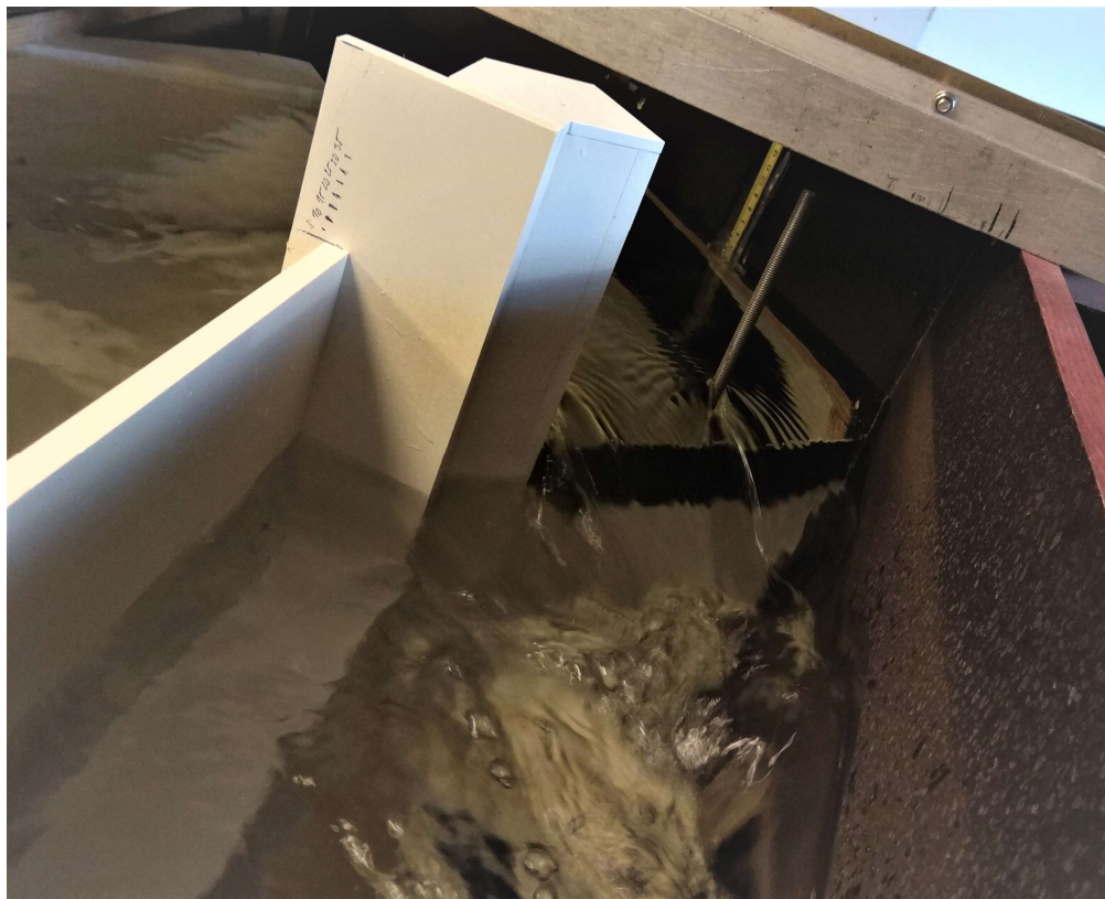
Obr. 28) Měření při přepadu vody pouze přes pevné stavidlo
