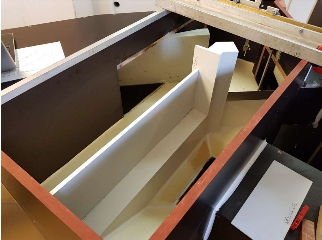
Obr. 27) Deska v místě tabulového uzávěru zajišťující přepad vody pouze přes pevné stavidlo
