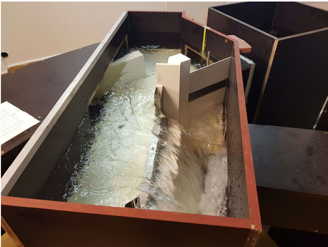
Obr. 29) Měření při přepadu vody pouze přes pohyblivý tabulový uzávěr
