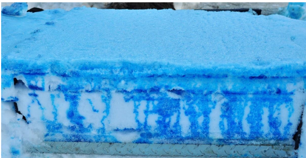
Obr. 9 – Přechod počátečního matricového proudění na preferenční proudění (foto autor).
