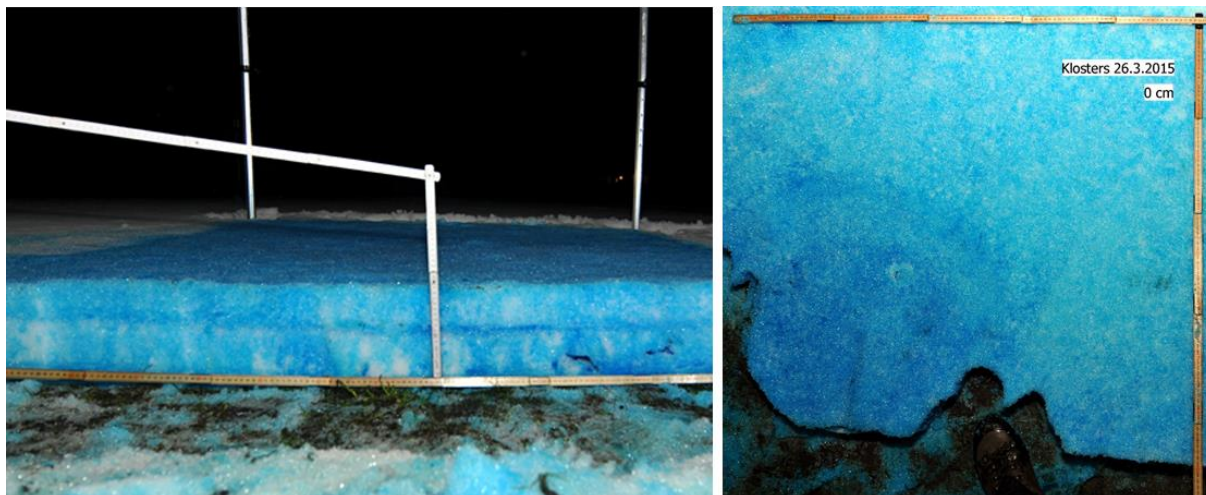
Obr. 22 – Řezy vyžralou sněhovou pokrývkou po experimentu L4 znázorňují rovnoměrný tok celou pokrývkou.
