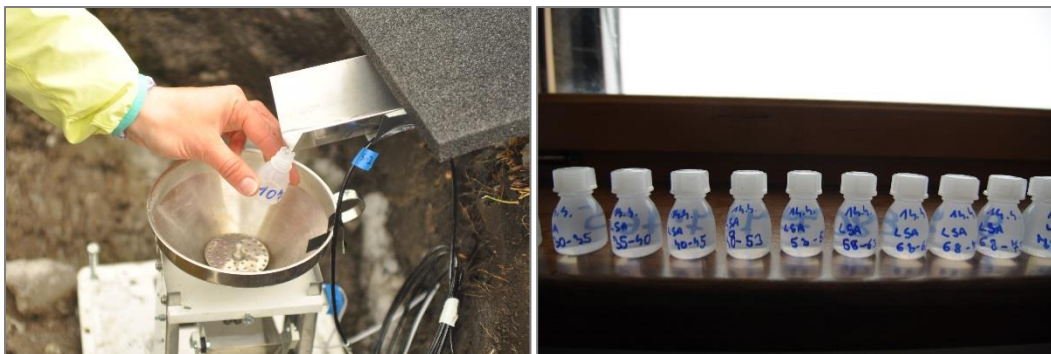
Obr. 14 – A) Odběr vzorku vody na odtoku B) Rozpuštěné vzorky odebraného sněhu v 10 ml lahvičkách (foto: autor).
