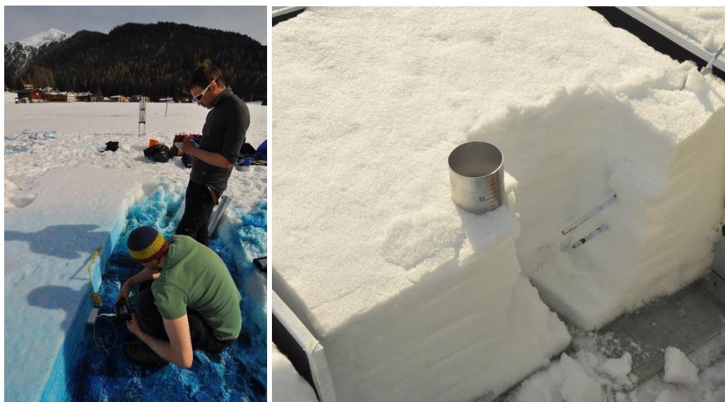
Obr. 15 – Analýza vlastností sněhové pokrývky po experimentu. A) Měření vlhkosti sněhu v profilu, B) Měření celkové hustoty a odkrytá teplotní čidla na měření teploty sněhové pokrývky během experimentu (foto: autor).
