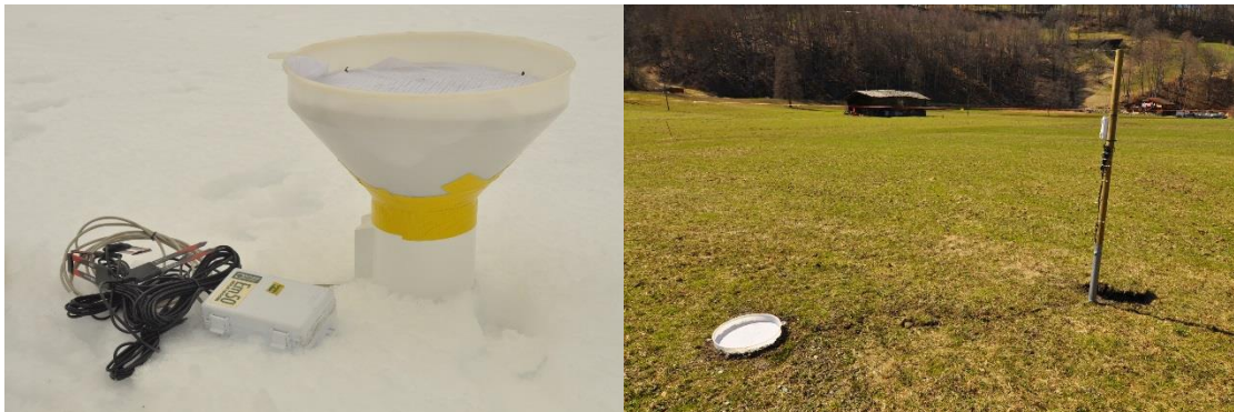
Obr. 12 – A) Lysimetr spojený s člunkovým průtokoměrem – celkový pohled před instalací. B) Instalace lysimetru a dataloggeru v terénu před zimní sezónou (foto: autor).
