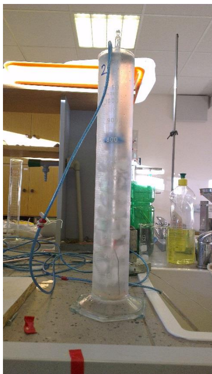
Obr. 18 – Laboratorní kalibrace teplotních čidel (foto: autor).
