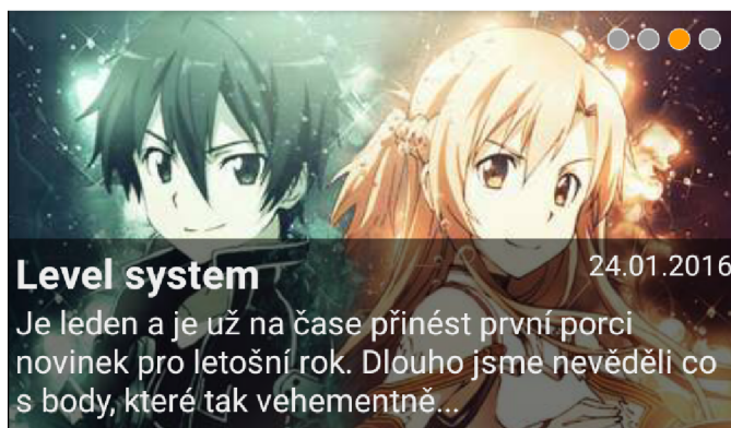
Obrázek 5.4: Ukázka použití ViewPagerIndicator ve spojení s ViewPager pro zobrazování novinek. Prvek indikátoru stránkování je umístěn v pravém horním rohu.
