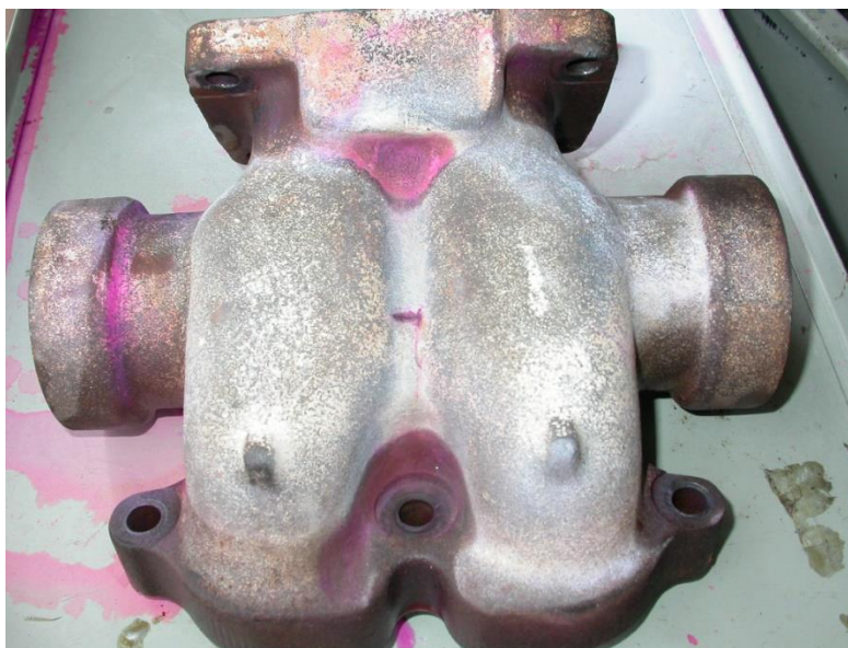
Obrázek 17 – Příruba turbodmychadla pro krátké šrouby
