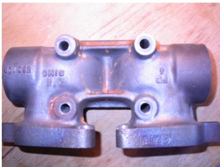
Obrázek 18 – Příruba turbodmychadla tuhé konstrukce s dlouhými průchozími šrouby
