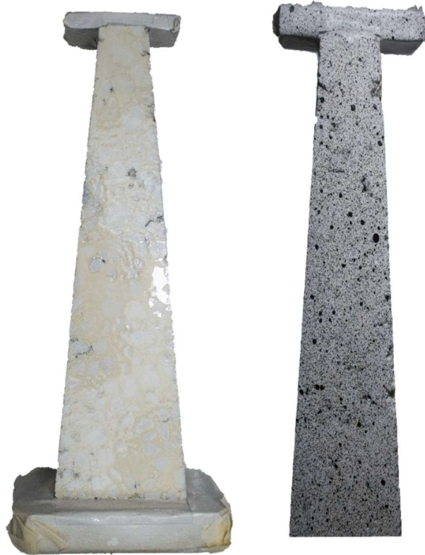
Obrázok 34: Vľavo - skúšobné teleso po nástreku podkladnej bielej farby; vpravo – skúšobné teleso po nástreku vzoru čiernych bodiek
