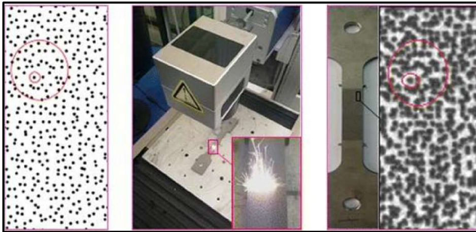
Obrázok 19: Laserové gravírovanie vzoru bodiek, prevzaté z [38]
