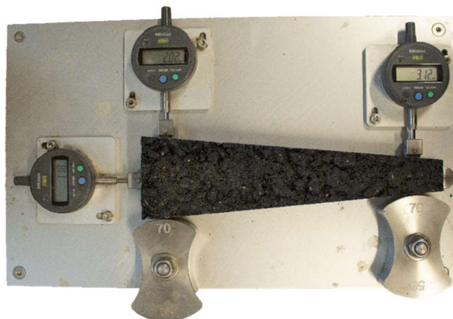
Obrázok 31: Presné meranie rozmerov skúšobného telesa
