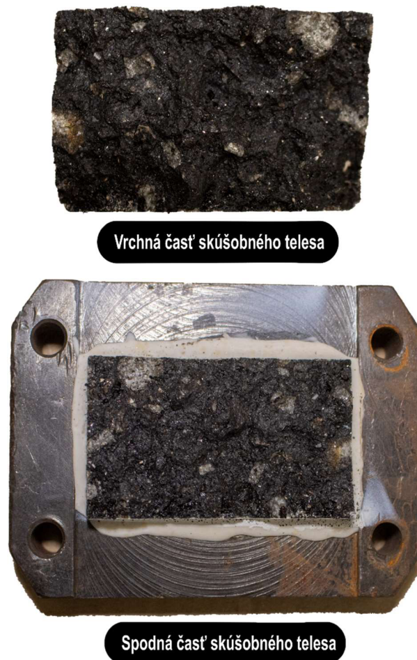
Obrázok 43: Prvé skúšobné teleso – mechanicky rozdelené teleso na dve časti
