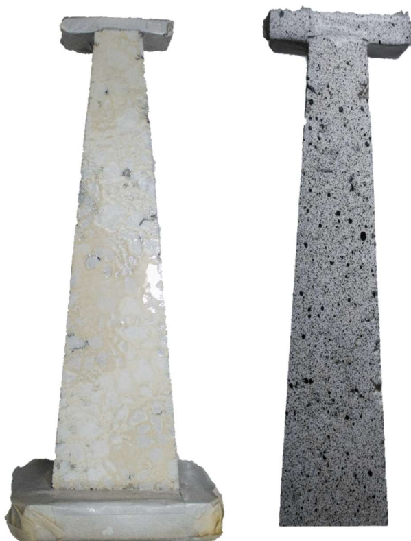
Obrázok 34: Vľavo - skúšobné teleso po nástreku podkladnej bielej farby; vpravo – skúšobné teleso po nástreku vzoru čiernych bodiek
