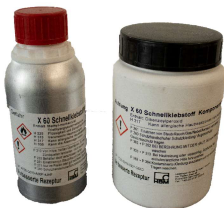
Obrázok 32: Vľavo - špeciálne tekuté lepidlo; vpravo – prášok k lepidlu
