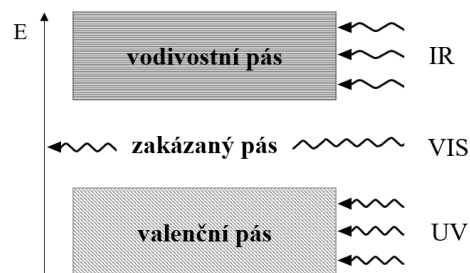
Obrázek 4: Pásová struktura transparentního vodivého oxidu (jakým může být ITO). Materiál propouští viditelné záření (VIS), ale ne infračervené (IR) nebo ultrafialové (UV) záření. (vlastní)
