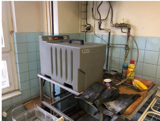
Obr. 20 Zařízení na rozpouštění materiálu podpory
