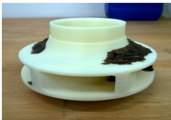
Obr. 18 První krok čištění materiálu podpory
