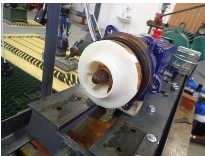
Obr. 32 Montáž kompozitového oběžného kola
