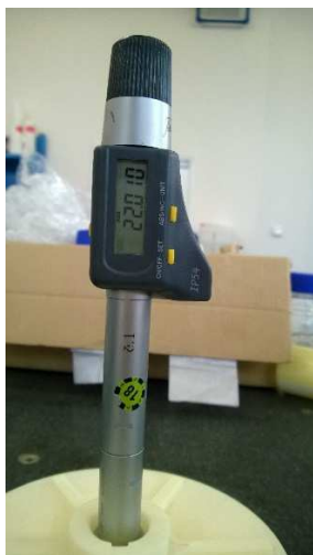
Obr. 22 Oběžné kolo – finální rozměrová kontrola
