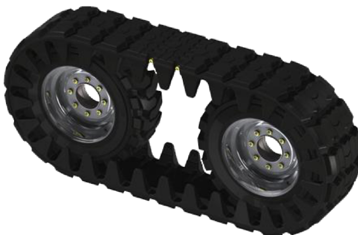
Obr. 3.2, OTT pás nasazený přes kola smykem řízeného nakladače[15]
