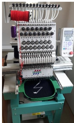
Obr. 54. Tvorba vyšívky na vyšívacím stroji Tajima
