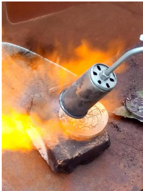
Obr. 94: nahřívání odlitku před retuší bronzovou elektrodou
