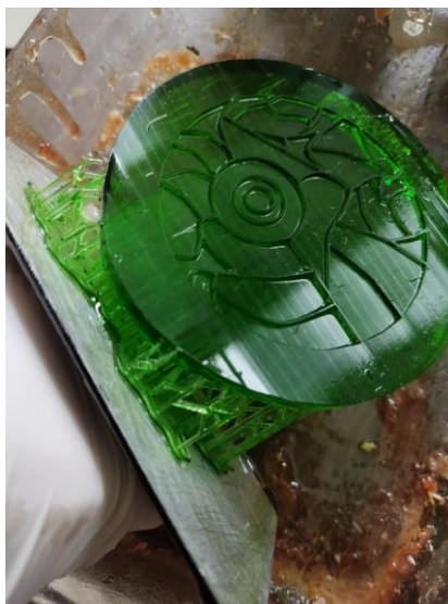
Obr. 90: hotový tisk, připravený k očištění
