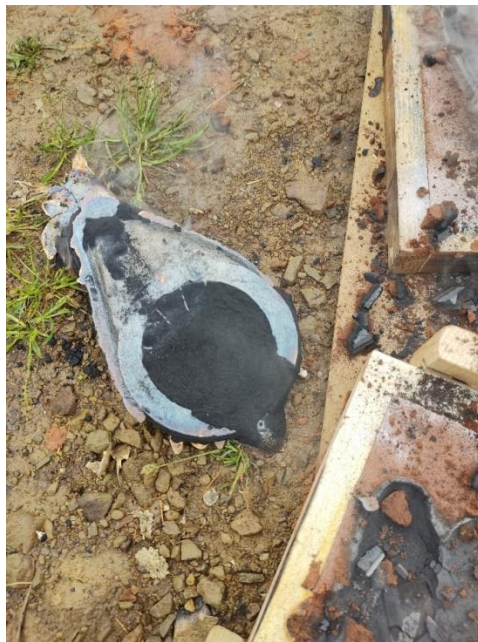
Obr. 93: odlitek s trychtýřovým nálitkem
