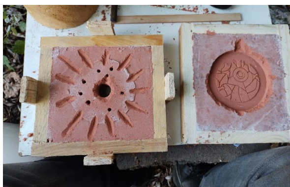
br. 91: dusání modelu do dřevěných ohrádek
