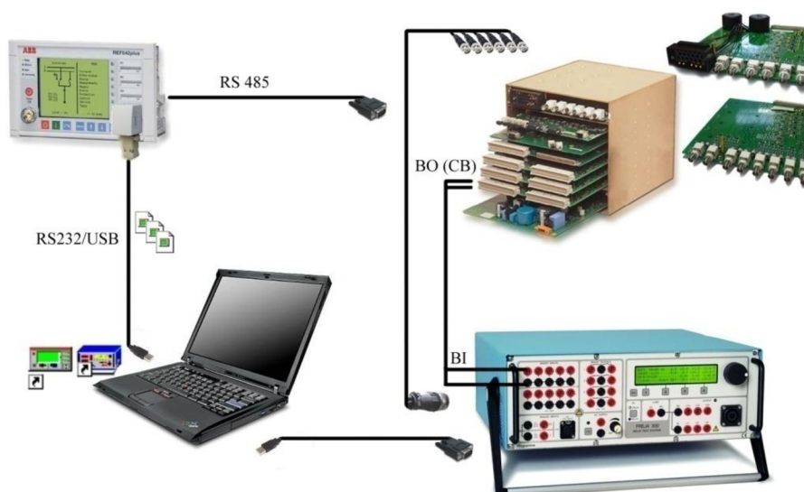
Obr. 8-2 Zapojenie meracieho pracoviska pre sekundárne skúšky.
