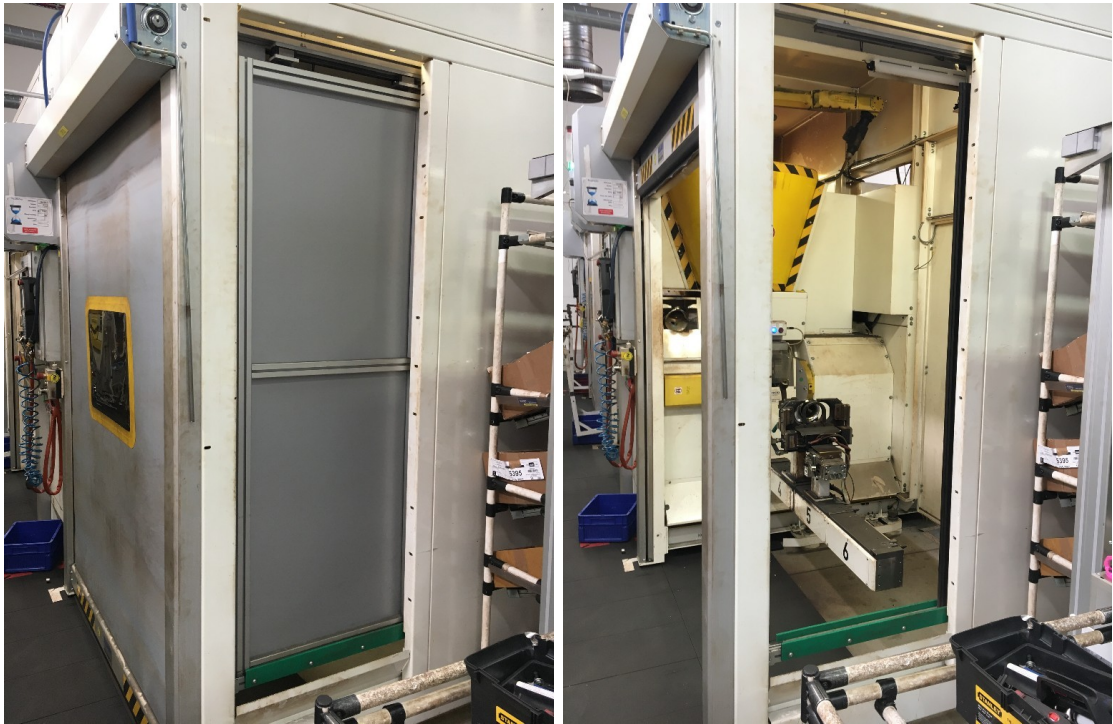
Obrázek 5.2: Boční pneumatické posuvné dveře svařovacího robota.
