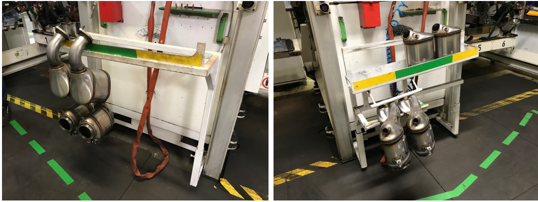
Obrázek 5.3: Ukázka mezioperačních zásobníků.
