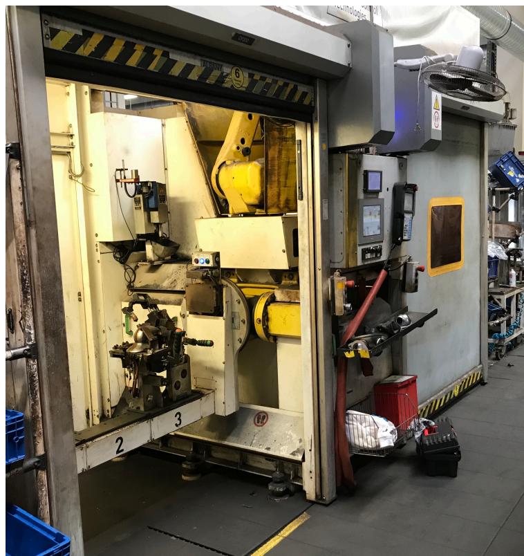
Obrázek 4.2: V-cell, svařovací robot.
