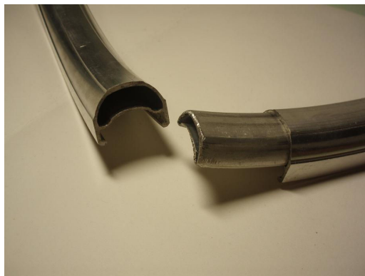
Obr.23 Příklad spoje pomocí tvarové spojky
