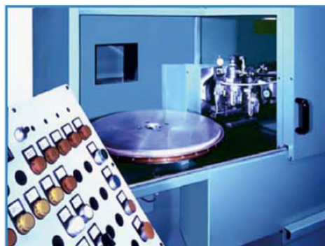
Obr.13 Stroj na soustružení brzdných ploch na ráfku [8]
