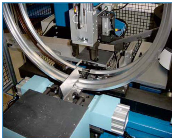
Obr.21 Spojování ráfku na stroji CERA
