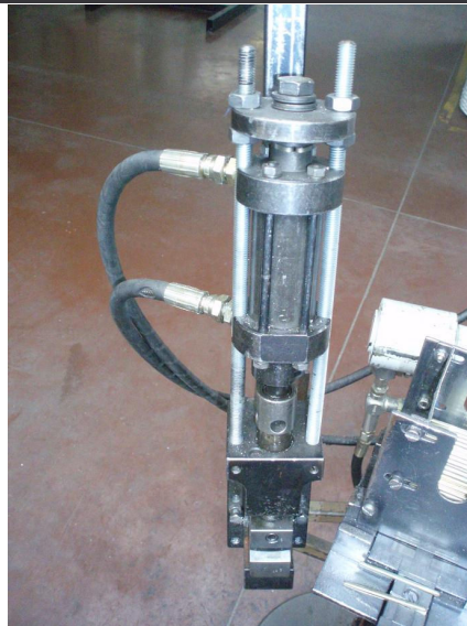
Obr.22 Přípravek sloužící k prohnutí kolíků pro malé průměry ráfku
