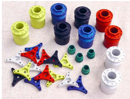
Obr.12 Různé zbarvení eloxovaných dílců [7]
