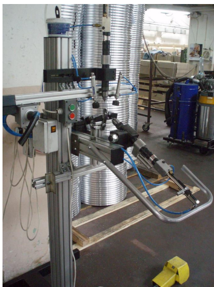
Obr. 25 Stroj pro navrtávání děr k dávkování lepidla
