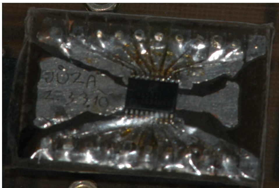
Obr. č. 13 Redukce TSSOP-20 na DIL20
