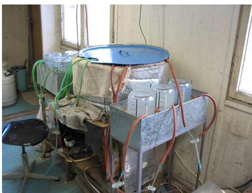
Obr. 29 Malé laboratorní fermentory
