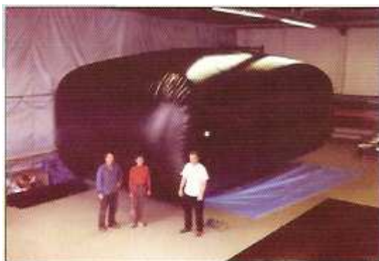
Obr. 3 Plynojem – střecha fermentoru (schéma + realizace) [8]
