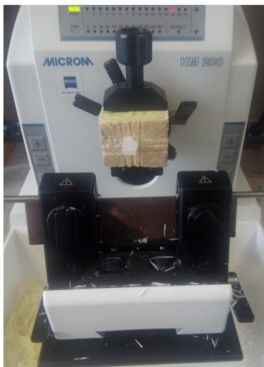
Příloha 4: Posuvný mikrotom s připraveným vzorkem.
