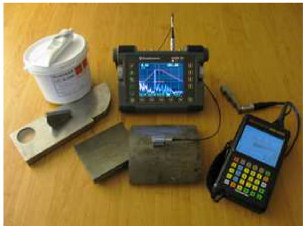
Obr. 4 Zařízení pro zkoušku ultrazvukem [29]
