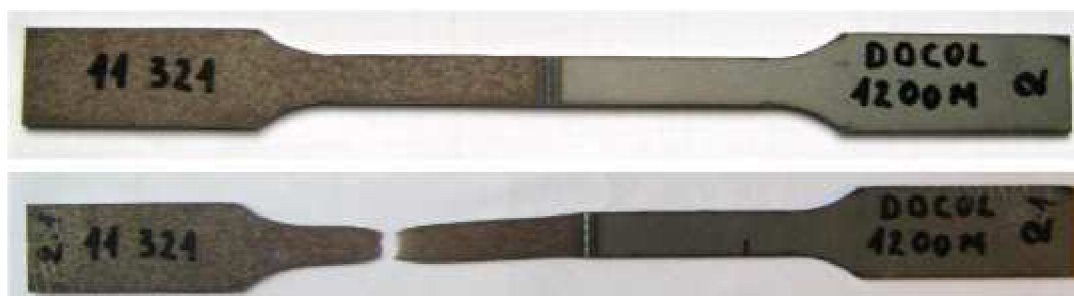
Obr. 11 Vzorek před příčnou zkouškou tahem a po zkoušce [15]
