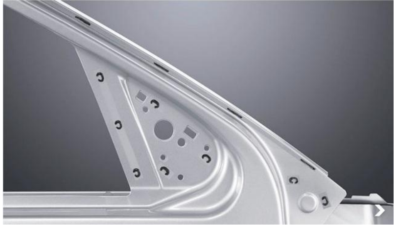
Obr. 21 Dveře automobilu svařované laserem [33]
