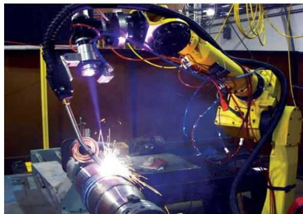
Obr. 1 Laserové svařování karoserie auta [3] Obr. 2 Hybridní laser – obloukové svařování [17]
