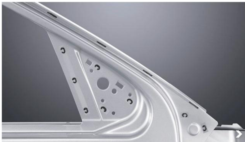
Obr. 21 Dveře automobilu svařované laserem [33]
