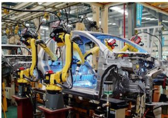
Obr. 1 Laserové svařování karoserie auta [3] Obr. 2 Hybridní laser – obloukové svařování [17]
