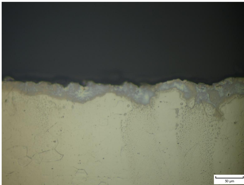
Obr. 34 Přechod mezi základním materiálem a vrstvou zinku
