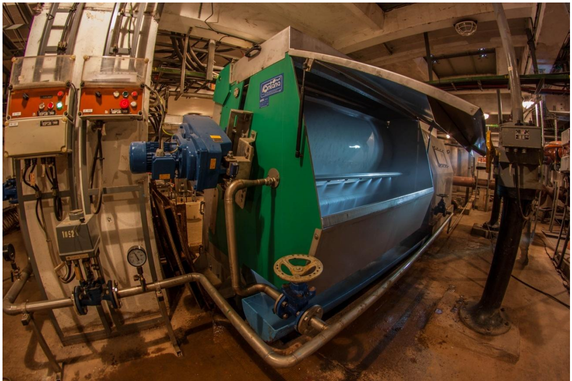
Obrázek č. 3 – Jemné česle umístěné před čerpací stanicí surové vody, zdroj: autor
