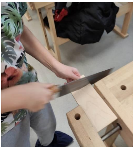
Obrázek 5 Řez s čepovkou (Vlastní zpracování)
