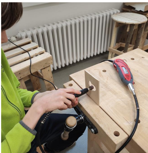
Obrázek 13 Broušení s modelářskou bruskou (Vlastní zpracování)
