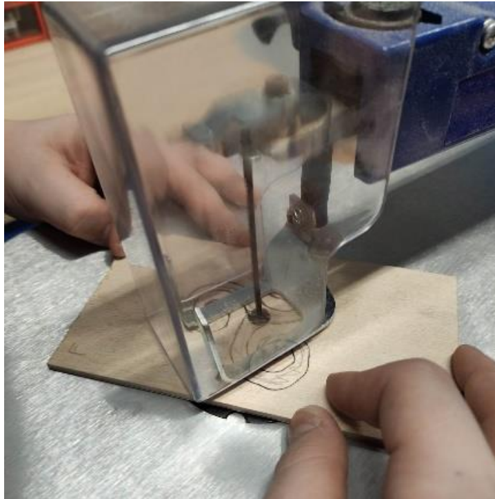
Obrázek 11 Práce se strojní lupínkovou pilou (Vlastní zpracování)
