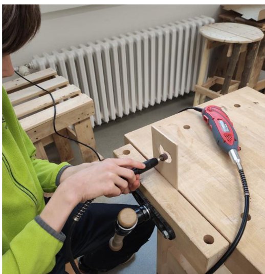
Obrázek 13 Broušení s modelářskou bruskou (Vlastní zpracování)
