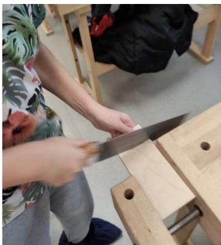
Obrázek 5 Řez s čepovkou (Vlastní zpracování)
