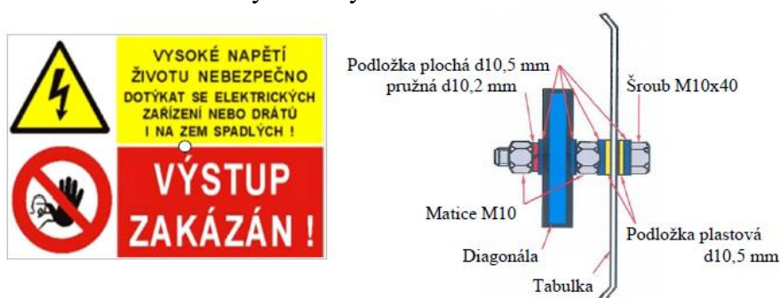
Obrázek 2.9 - Detail bezpečnostní tabulky a jejího uchycení [8]
