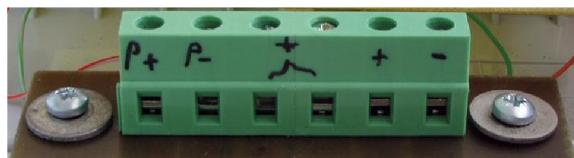
obr. 15: Svorkovnice na „vysílací“ části proudové smyčky
