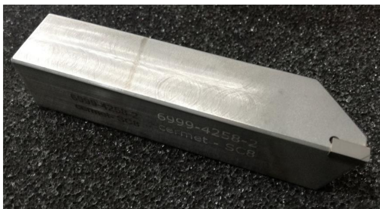
Obr. 4.1 Soustružnický nůž s připájeným břitem z cermetu.
