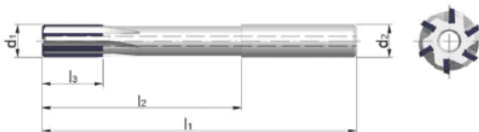
Obr. 2.23 Výstružník z cermetu s válcovou stopkou a s vnitřním chlazením [25].
