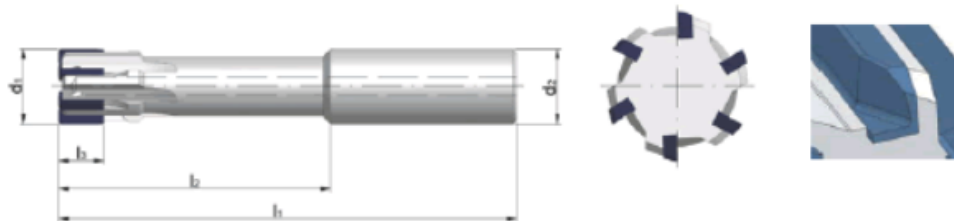
Obr. 2.25 Výstružníky z cermetu s válcovou stopkou, SN geometrií a s vnitřním chlazením [25].
