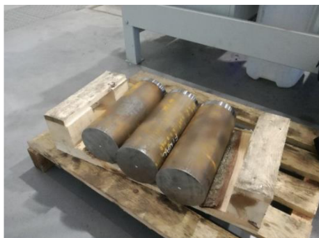
Obr. 4.2 Materiál polotovaru z oceli 12 050.3.
