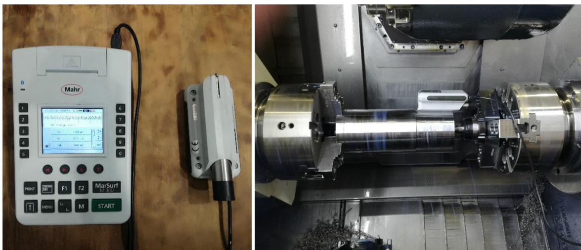
Obr. 4.4 Drsnoměr Mahr MardSurf M 300.
