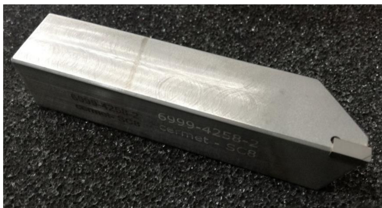
Obr. 4.1 Soustružnický nůž s připájeným břitem z cermetu.
