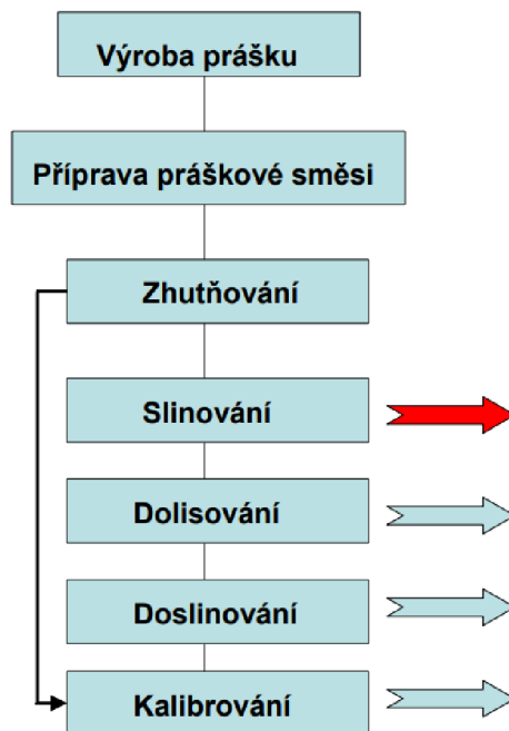
Obr. 1.2 Schéma výroby cermetů [11].
