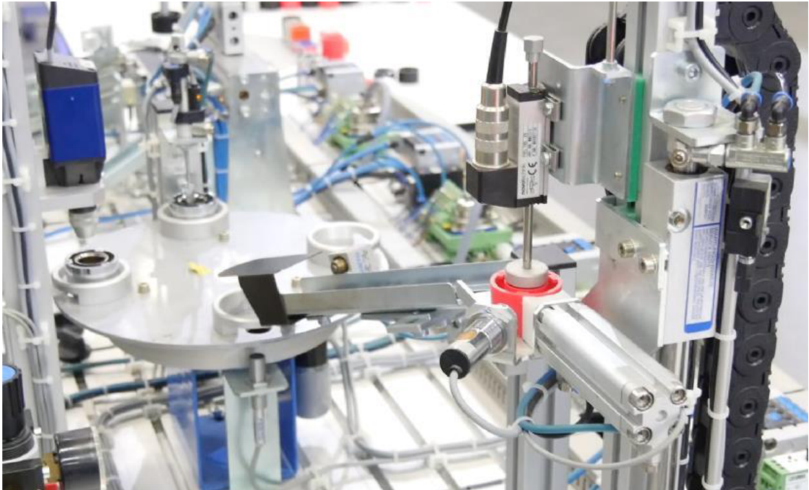
Obrázek 17 – Ukázka simulované fyzické výrobní linky, konkrétně stanice řízení výšky a procesní stanice [34]
