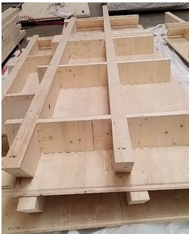
Obr. 19 Kompletace a balení CLT stropního panelu se středem z roštu BSH (tzv. Novatop Element) (Foto: Autor)
