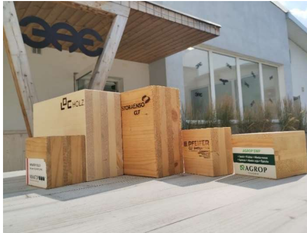
Obr. 2 Technologie křížem lepeného dřeva různých výrobců (Foto: Autor)
