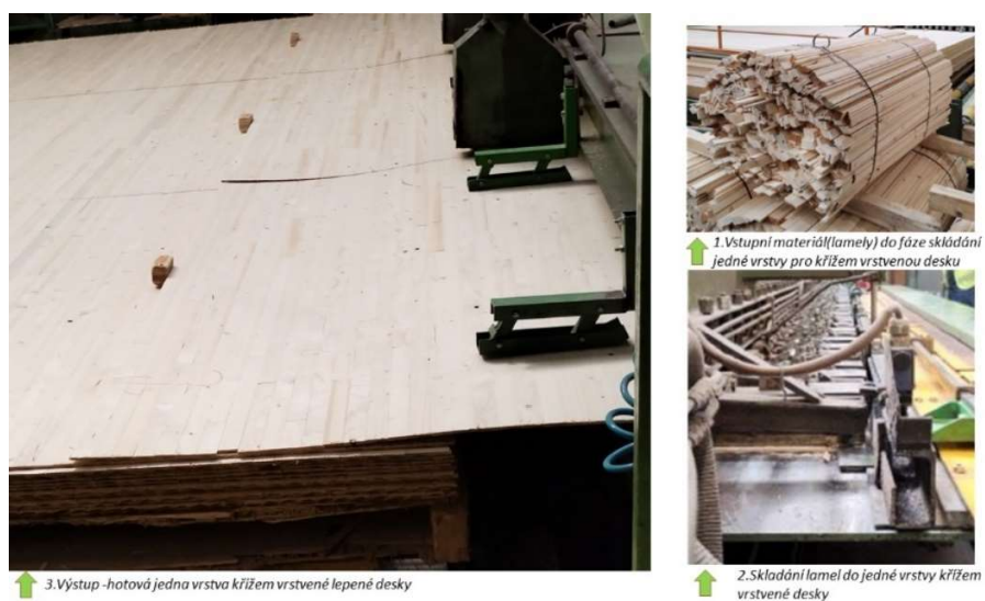
Obr. 11 Výroba jedné vrstvy křížem vrstvené desky (Foto:Autor)
