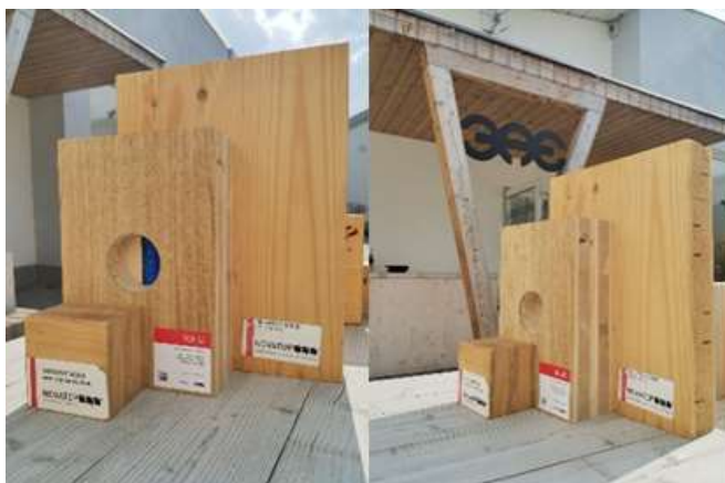
Obr. 5 Technologie systému CLT výrobcem Novatop(Foto:Autor)
