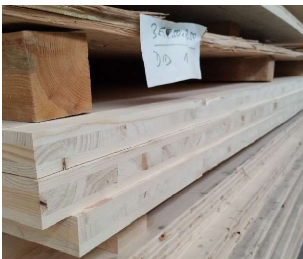
Obr. 16 Zbroušení desky do finálního povrchu (zrnitost nejčastěji 50 a 100) (Foto: Autor)
