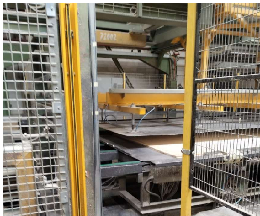
Obr. 12 Fáze křížové vrstvení desky a lisování (Foto:Autor)
