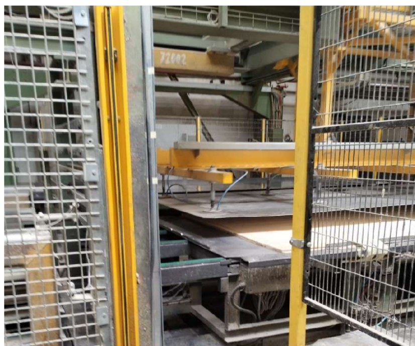
Obr. 12 Fáze křížové vrstvení desky a lisování (Foto: Autor)
