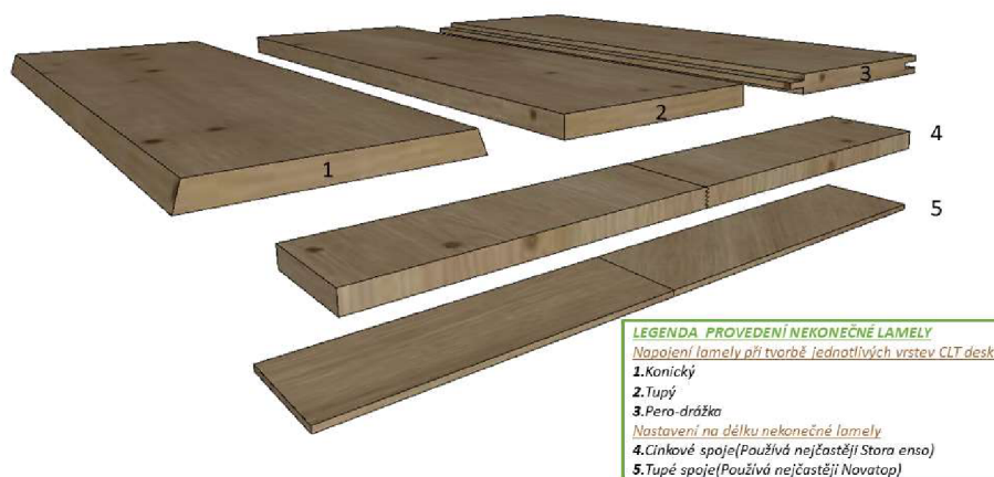
Obr. 6 Provedení různých napojení lamel při výrobě vrstev CLT panelu (ZIMARK, 2014, upraveno: Autor)
