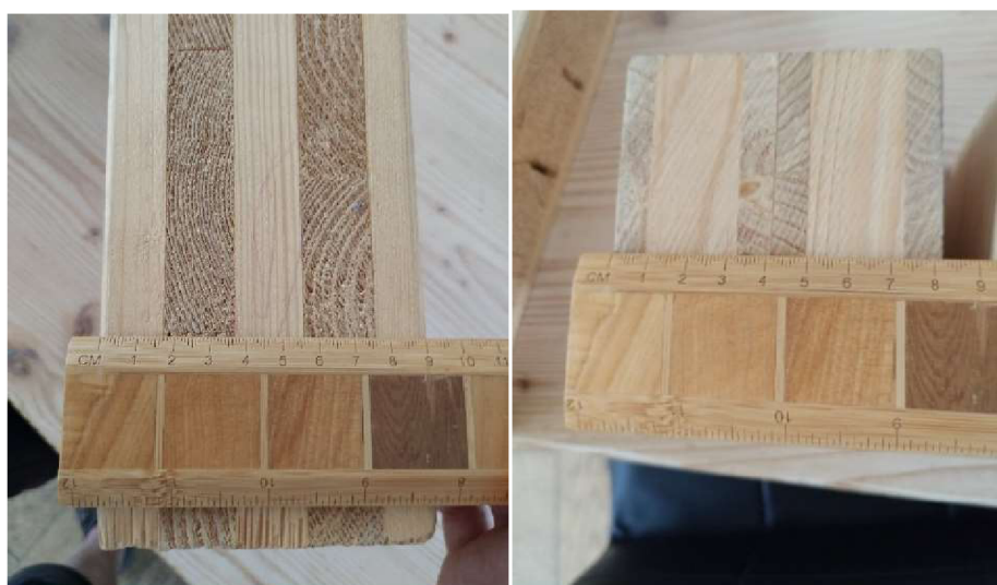
Obr. 10 Ukázka vícevrstevných CLT panelu včetně standardních rozměru od výrobce Stora enso (vlevo)
