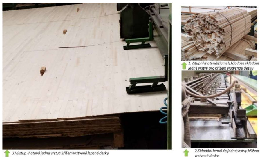
Obr. 11 Výroba jedné vrstvy křížem vrstvené desky (Foto: Autor)
