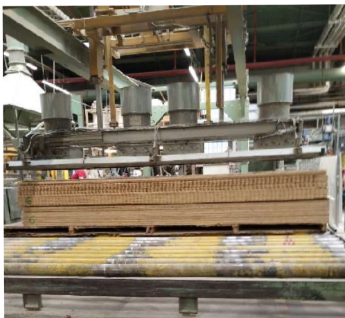
Obr. 13 Lisování a vytvrzení souboru křížem vrstvené desek většího počtu (Foto:Autor)
